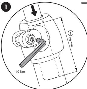
Řídítka zasuněte do sloupku vidlice a utáhněte šroub. Řídítka se přitom značkovými minimálními hloubkami zasunují!
