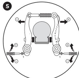
Otáčením nastavovacího šroubu vycentrujte nyní ramena brzd na střed. Potřebujete speciální křížový šroubovák. Je důležité, aby se přitom brzdová páka několikrát stlačila, tím se rovnoměrně rozdělí napětí brzdových ramen na obě strany a nastavení bude účinné. Kontakt tělesa brzd/ráfku se musí vyskytovat na obou stranách současně.
