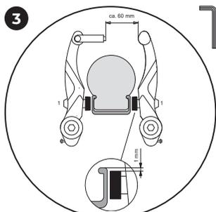
**Indstillingskontrol og finjustering af bremsen (V-brake). Kun til model LR XL.** Kontrollér, at begge bremsebelægninger er parallelle og positioneret korrekt på fælgen. Det vil sige, de skal sidde ca. 1 mm under fælgens overkant. Hvis indstillingen ikke er korrekt, løsner du bremsebelægningens møtrik (1) og justerer den som beskrevet ovenfor. Træk bremsehåndtaget og spænd møtrikken igen (5-8 Nm).
