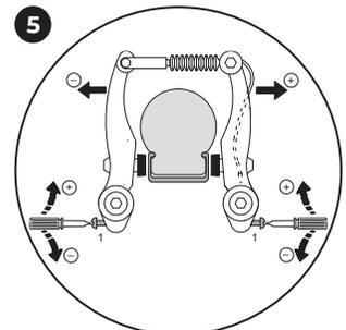
Durch Drehen der Einstellschraube, justieren Sie nun die Bremsarme mittig aus. Sie benötigen einen gesonderten Kreuzschlitz-Schraubendreher. Wichtig ist, dass die Bremshebel dabei mehrmals betätigt werden, damit sich die Spannung der Bremsarme auf beiden Seiten gleichmäßig verteilt und die Einstellung wirksam wird. Der Kontakt Bremskörper-/ Felge muß auf beiden Seiten gleichzeitig auftreten.
