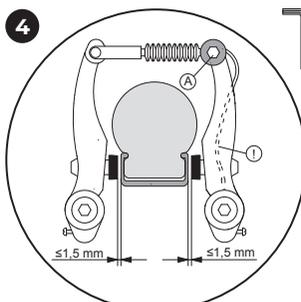
La tensione del cavo del freno è regolata al dado di fissaggio (A) in modo tale che la guarnizione del freno si trovi a una distanza di rispettivamente ca. 1,5 mm.
