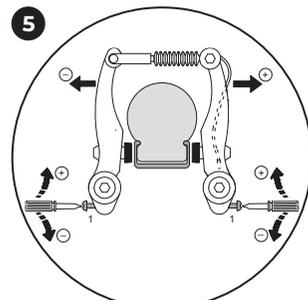
Pokręcając śrubą regulacyjną ustawić centralnie ramiona hamulcowe. Do tego potrzebny jest specjalny wkrętak krzyżowy. Przy tym wielokrotnie uruchomić dźwignię hamulcową, aby napięcie ramion hamulcowych rozłożyło się równomiernie po obu stronach, co stanowi podstawę skutecznej regulacji. Kontakt klocka hamulcowego z obręczą koła musi być jednocześnie na obu stronach.
