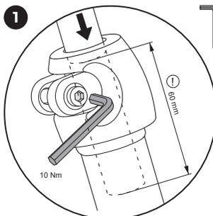
Inserire il manubrio nel tubo della forcella e stringere la vite. Fare attenzione alla marcatura del livello minimo di inserimento!
