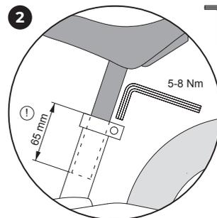
Une fois le collier de sel desserré, la selle peut être remontée (respecter la profondeur d'enfoncement minimale!). Resserrez ensuite le collier de selle (5-8 Nm). Le frein de ce véhicule a été pré-monté et réglé par PUKY.
