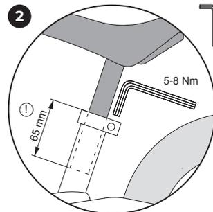
Po poluzowaniu zacisku siodełka można je wyciągnąć (przeszeregnać minimalnej głębokości wetknięcia). Następnie ponownie dokręcić (5-8 Nm). Hamulec tego pojazdu został zamontowany i wyregulowany przez PUKY.
