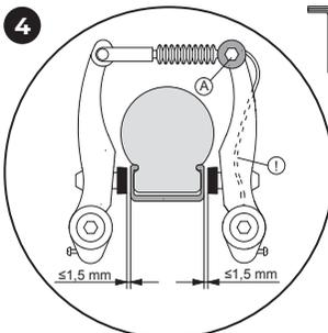
Die Spannung des Bremszuges ist an der Verankerungsmutter (A) so eingestellt, dass der Bremsbelag jeweils ca. 1,5 mm von der Felge entfernt ist. Sollte eine Justierung erforderlich sein, muss das überstehende Drahtende danach wieder an der Bremse festgeklemmt werden.
