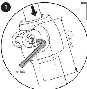
Steek het stuur in de vorkbuis en draai de schroef vast. Let daarbij op de marking voor de minimale insteekdiepte!
