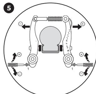
Поворачивая регулировочный винт, отрегулируйте плечо тормоза посередине. Вам потребуется крестовая отвертка. Важно, чтобы тормозные рычаги при этом многократно нажимались, чтобы натяжение тормозных плеч было одинаковым с обеих сторон, а регулировка — эффективной. Касание тормозящего элемента с ободом должно происходить одновременно с обеих сторон.
