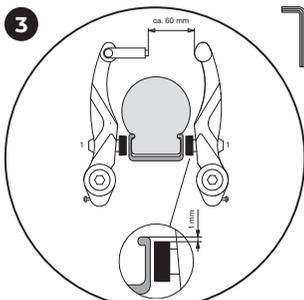
**Kontrola i doprecyzowanie ustawienia hamulca (V-Brake). Tylko model LR XL** Upewnić się, że obydwie okładziny hamulcowe są wzajemnie równoległe i właściwie ustawione względem obręczy koła. Muszą one znajdować się ok. 1 mm poniżej górnej krawędzi obręczy koła. Jeżeli ustawienie nie będzie prawidłowe, to należy poluzować śrubę mocującą okładzinę hamulcową (1) i wykonać regulację zgodnie z powyższym opisem. W tym celu pociągnąć za dźwignię hamulca i ponownie dokręcić śrubę mocującą (5-8 Nm).
