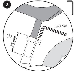
Zur Einstellung der Sattelhöhe die Sattelklemme lösen und anschließend wieder festdrehen. Mindesteinstecktiefe beachten! Die Bremsen an diesem Fahrzeug wurde bereits von PUKY vormontiert und eingestellt.
