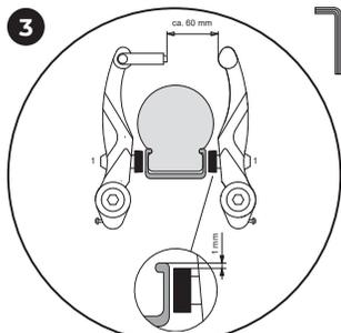
**Piduri (V-pidur) seadmine ja täpne reguleerimine. Ainult mudelil LR XL.** Veenduge, et piduriklotsid oleksid teineteise suhtes paralleelselt ja põia suhtes korrektselt joondatud. See tähendab, et piduriklotsid peaksid olema 1 mm kõrgusel põia ülemise ääre kohal. Kui selline seadistus pole korrekne, lõdvendage piduriklotsi (1) kinnitusmutrit ja joondage nagu ülalpool kirjeldatud. Selleks tõmmake pidurihooba ja kinnitage kinnitusmutter (5-8 Nm).
