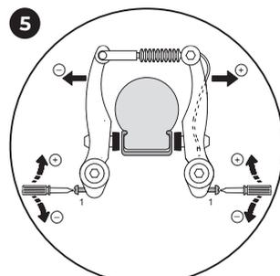
Nu centrerer du bremsearmene ved at dreje på indstillingsskruen. Dertil skal du bruge en stjerneskruetækket. I den forbindelse er det vigtigt at trække bremsehåndtaget flere gange, så bremsearmenes spænding fordeles sig ens på begge sider og så indstillingen virker. Bremsen skal virke ens på begge sider.
