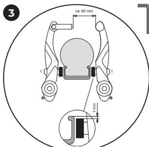
**Kontroll av inställningen och finjustering av bromsen (V-broms). Endast för modell LR XL.** Försäkra dig om att bromsklossarna ligger parallellt med varandra och att de är rätt placerade mot fälgen. Bromsklossarna ska sitta 1 mm under fälgens övre kant. Om denna inställning inte är korrekt, lossa på insexskruven på bromsklossen (1) och justera bromsklossen på det sätt som beskrivs ovan. För att göra detta, tryck ner bromshandtaget och dra åt insexskruven (5-8 Nm).
