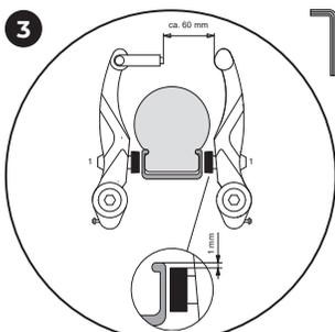
Контроль регулировки и точная юстировка тормозов (V-Brake). Только для модели LR XL. Удостоверьтесь, что обе тормозные накладки стоят параллельно друг другу и их положение на ободе выровнено. Это значит, что они расположены на 1 мм ниже верхнего края обода. В случае с неправильной регулировкой отвинтите крепежную гайку тормозной накладки (1) и отрегулируйте так, как описано выше. Нажмите тормозной рычаг и снова закрутите крепежную гайку (5-8 Nm).
