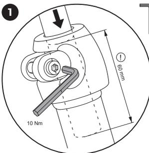
Insérer le guidon dans la fourche et serrer la vis. Respectez le repère de la profondeur minimale!
