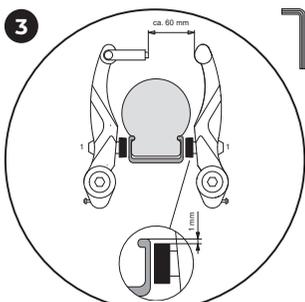
**Instellingscontrole en fijnafstelling van de rem (V-brake).** Alleen voor het model LR XL. Zorg ervoor dat beide remblokken parallel staan en correct zijn uitgeijnd op de velg. Ze moeten op een afstand van ca. 1 mm onder de bovenkant van de velg staan. Als de instelling niet correct is, draait u de bevestigingsmoer van het remblok (1) los en stelt u het geheel in zoals hierboven beschreven. Trek aan de remhendel en draai de bevestigingsmoer weer vast (5-8 Nm).
