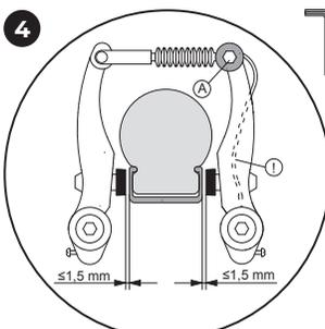
La tension du câble de frein est réglée au niveau de l'écrou d'ancrage (A) de manière à ce qu'il y ait un espace de 1,5 mm entre la garniture de frein et la jante.
