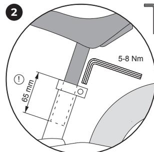
Минимальная глубина посадки седлодержателя составляет 65 мм. На седлодержателе находится соответствующая маркировка. Затем снова затяните зажим седла (Момент затяжки 5-8 Nm). Тормоза на этом транспортном средстве предварительно собраны и отрегулированы компанией PUKY.
