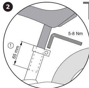
Efter løsning af sadelklemmen, kan sadlen trækkes ud (bemærk min. indstikdybde). Derefter spændes den igen (5-8 Nm). Bremsen på denne cykel er allerede formonteret og indstillet fra PUKY.
