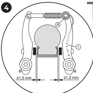
Piduritrossi pinget saab reguleerida ankurmutriga (A), et iga piduriklots oleks põiest 1.5 mm kaugusel. **Kohandamise vajaduse korral tuleb väljalatav traadi ots uuesti piduri külge kinnitada.**
