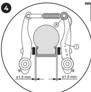
de spanning van de remkabel wordt zodanig met de borgmoer (A) ingesteld, dat de remblokkjes ca. 1,5 mm van de velg af staan. Als er een aanpassing nodig is, moet het uitstekende uiteinde van de draad daarna weer op de rem worden vastgeklemd.
