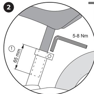
Po uvolnění svorky sedla lze sedlo vytáhnout (Zohledněte minimální zásuvnou hloubku!) Následně opět pevně utáhněte (5-8 Nm). Brzda na vašem vozítku byla již z výrobního závodu společnosti PUKY předmontována a nastavena.
