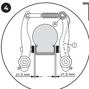
Bremsekablet er indstillet således på anker møtrikken (A), at bremsebelægningerne sidder ca. 1,5 mm fra fælgen. Hvis der kræves en justering, skal den udragende trådende spændes fast på bremsen igen efter justeringen.
