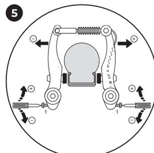
Centrera nu bromsarmarna genom att vrida på justerskruven. Du behöver en stjärnskruvmejsel för detta. Det är viktigt att du justerar spänningen och trycker ner bromshandtagen flera gånger för att kontrollera att bromsarmarna träffar respektive fälg sida samtidigt och att inställningarna har effekt. Bromsens kontakt med fälgen måste vara identisk på bägge sidor.
